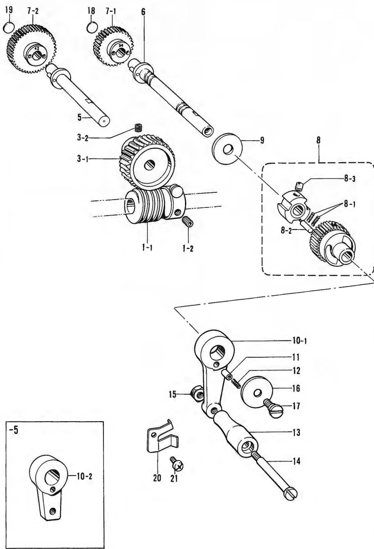
M. カム伝導関係 / Feed cam mechanism / Transporteurkurve /
