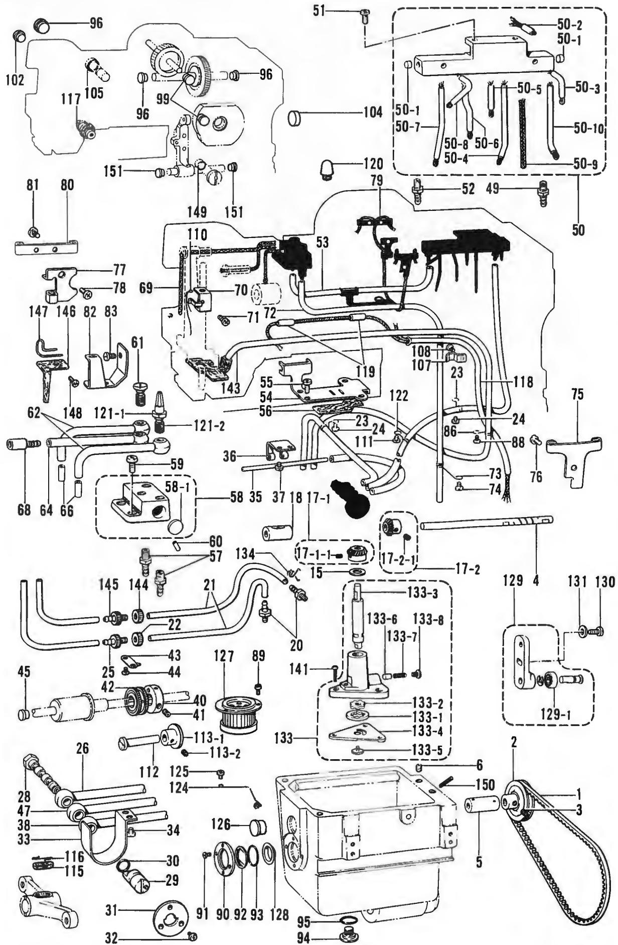
T. 給油潤滑関係 / Lubrication/Schmierung/Lubrification/Lubricación
