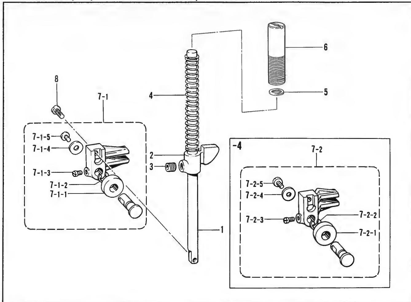
K. 押工関係 /Presser foot mechanism/Stoffdrückerfuß/
