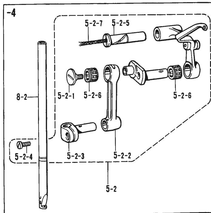
B. 針棒関係 / Needle bar mechanism / Nadelstangenvorrichtung /
