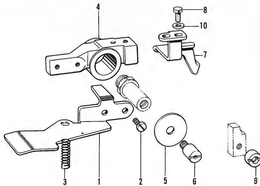
J. テンションプーリー関係 / Tension pulley mechanism / Spannrolle /
